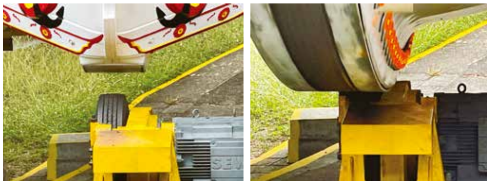
↑ 輪胎轉動與船身產生摩擦力而擺動。
