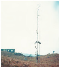
二東山上安裝的風切變監測儀器
